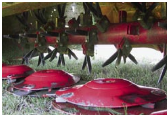
Conditionneur à dents intégré
